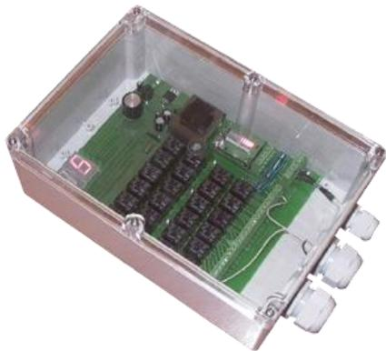
Блоки А-02, А-02-1 предназначены для управления продувкой фильтров-циклонов. Блоки обеспечивают формирование регулируемых по длительности и периоду импульсов поочередно на заданном количестве выходов, к которым подключаются электропневмоклапаны (ЭПК) подачи сжатого воздуха для очистки от пыли рукавов фильтра-циклона. Блоки защищены от перегрузок по току и коротких замыканий в цепи нагрузки.
