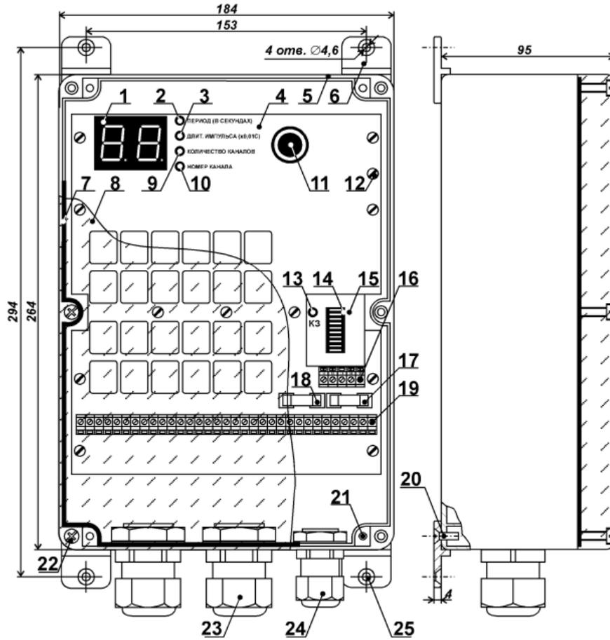
**Схема подключения и органы управления блока А-02:**
